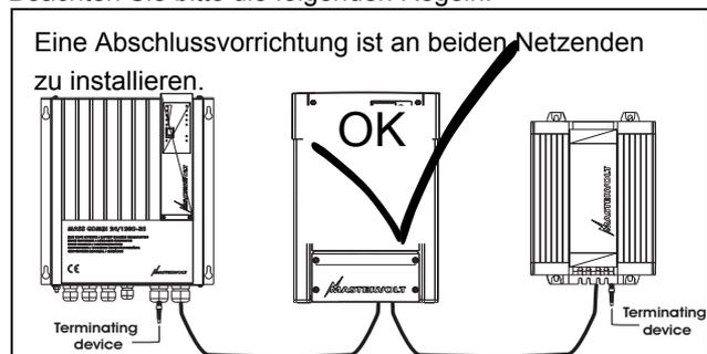
Anschlüsse zwischen den Geräten erfolgen durch geradlinige Standard-UTP-Patch-Kabel.
